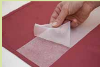
2.) Ablösen des textilen Abdeckbandes / removal of textile cover tape
