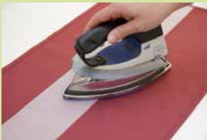
1.) direktes Anbügeln Art. 20560/100-T auf textiler Seite / direct ironing of art. 20560/100-T on textile surface
